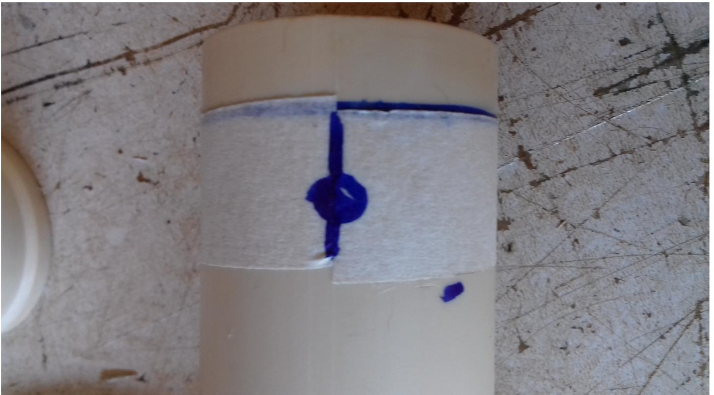
Agora você fará uma marca no topo do cano, após colocar a tampinha de vedação. A minha tem uma altura de 2 cm. Coloque e risque até onde ela chega.
