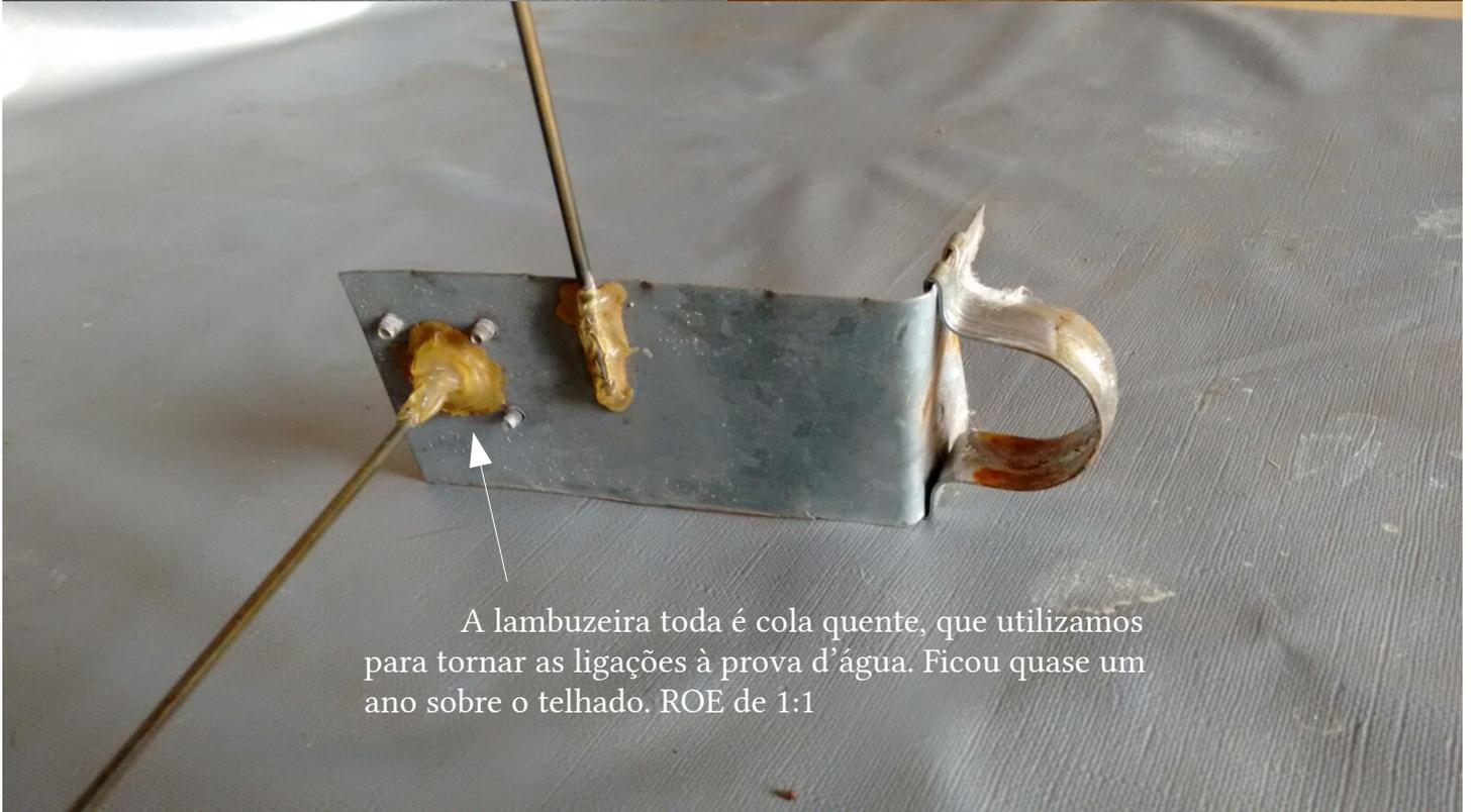
A lambuzeira toda é cola quente, que utilizamos para tornar as ligações à prova d'água. Ficou quase um ano sobre o telhado. ROE de 1:1
