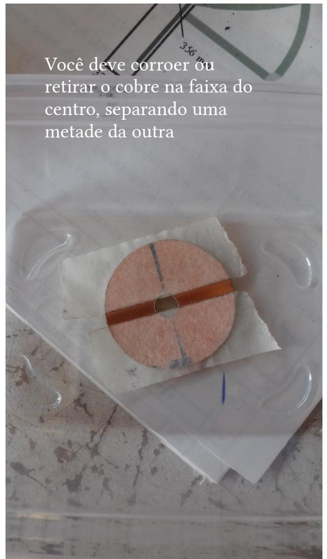
Fizemos vários furinhos na parte que queríamos desbastar. Com eles, fica mais fácil cortar com o alicate de corte. O diâmetro desta plaquinha é pouco menos que 4 cm, suficiente para entrar um pouco justa no cano de PVC.
