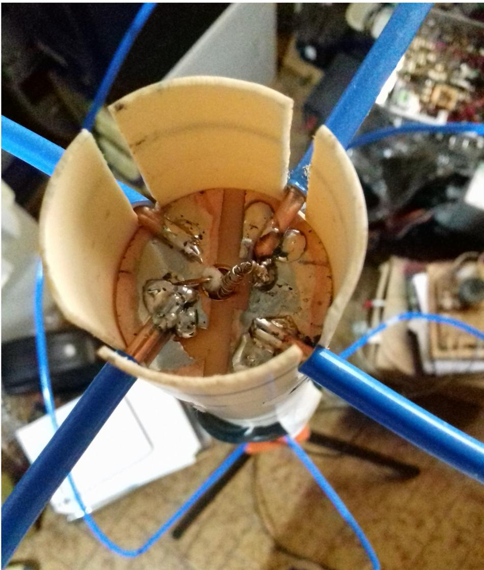
Outro segredo: faça a soldagem dos fios depois de soldar o cabo coaxial e quando estes estiverem já armados dentro do cano. Como os fios de cobre são grossos, é muito importante que eles estejam armados na sua posição final, senão a solda solta do cobre da plaquinha de circuito impresso.
