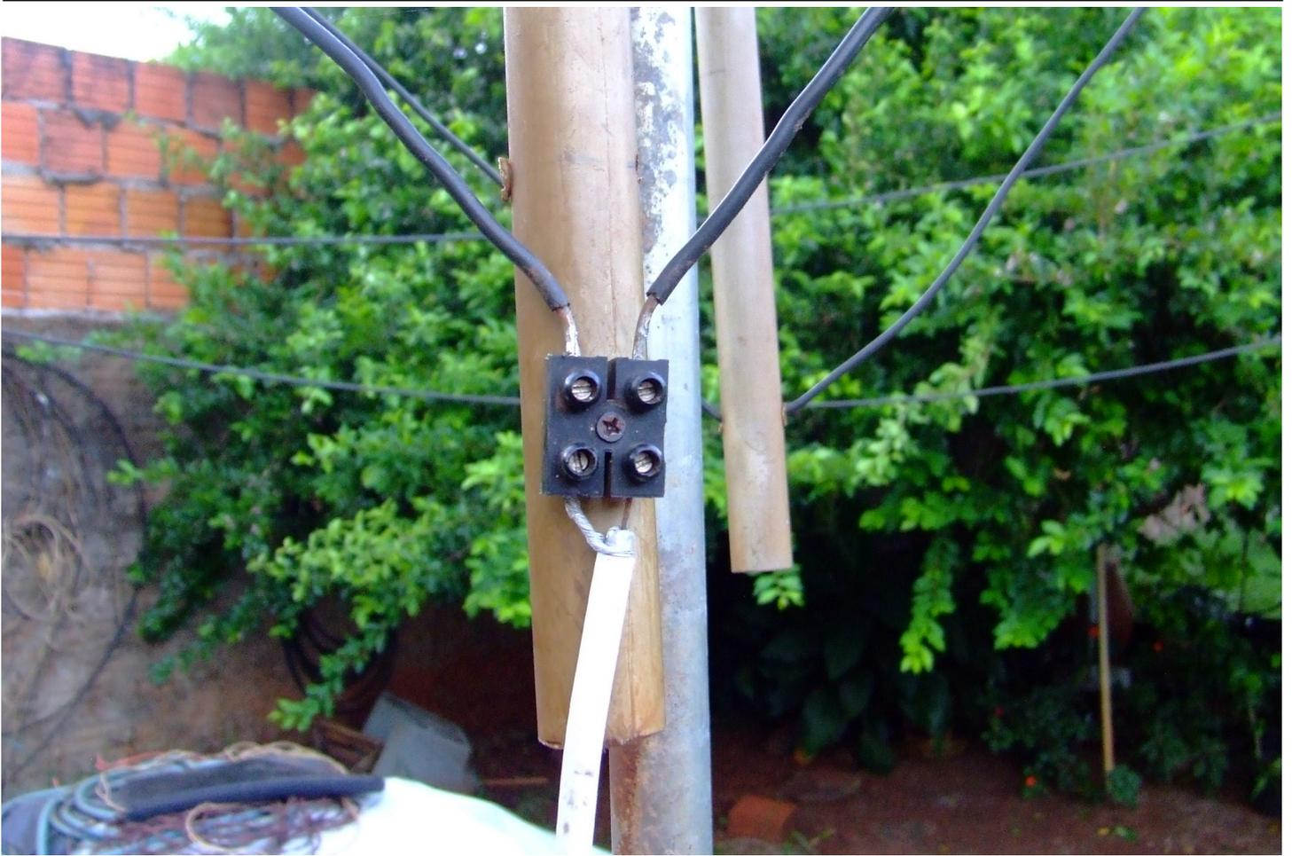
Aí está o conector SINDAL prendendo o quadro irradiante da antena e o cabo coaxial, neste caso o acoplador de 75 ohms. Cruzetas e “T” de PVC podem ser apenas encaixados, transformando nossa anteninha de VHF para operação portátil, fácil de colocar no porta malas do carro,
