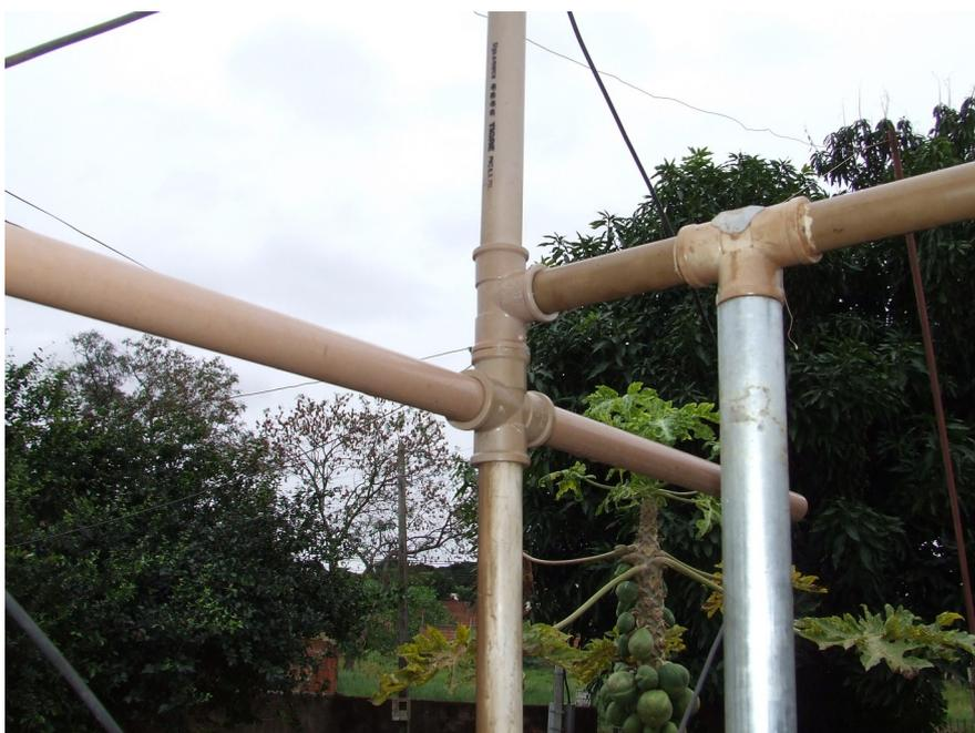
Este “macete” é um segredo até desconhecido por muitos radioamadores. O uso de “t”, curvas e cruzetas em PVC torna fácil não só montar a estrutura de uma antena, mas de fixá-la também num mastro. A foto ao lado dá uma ideia de como fizemos nossa Quadra Cúbica de dois elementos para a faixa de VHF.
