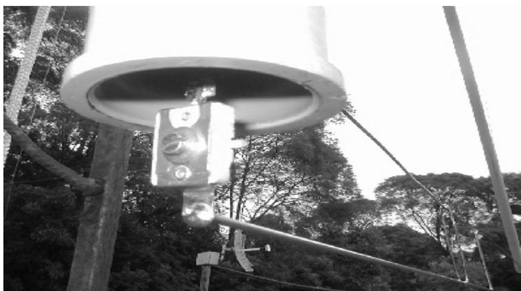
Veja a montagem do capacitor no gama de ajuste da antena. Montagem do capacitor no gama do elemento irradiante. Protegendo o capacitor contra intempéries, para a proteção do capacitor foi utilizado um conjunto feito de cano de PVC de 40mm e com duas tampas de PVC. Deste modo temos a vedação completa aplicando ainda uma camada de cola borracha de silicone. Montagem para a proteção do capacitor de ajuste no gama.
