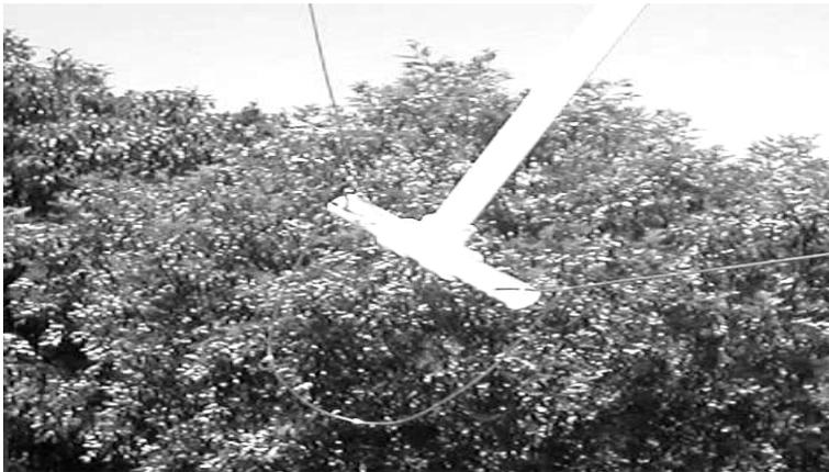
No elemento refletor construímos um "T" em um dos braços.
