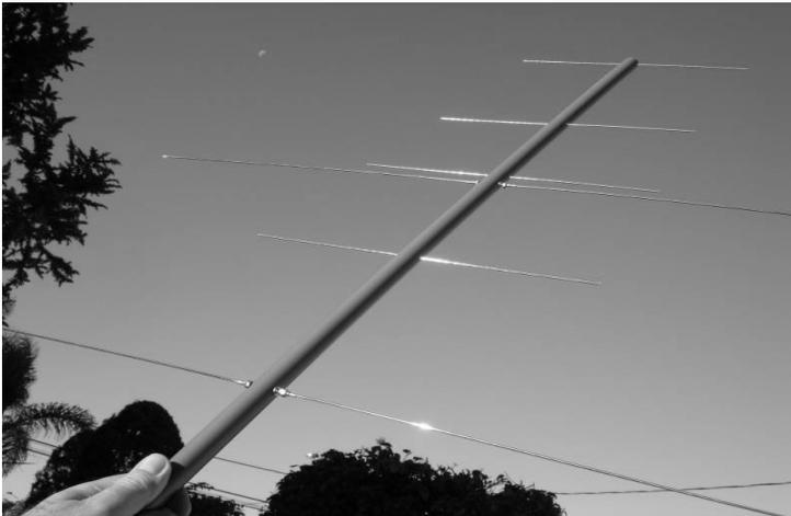
Contrariando a simulação do MMANA(software), o refletor de UHF ficou melhor com 350mm. de comprimento...
