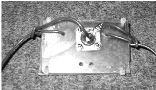
Foto 2 - Solda-se os fios da antena conforme demonstrado ao lado. Um fio no centro do Conector SO239 e o outro na carcaça, preso no parafuso que prende o conector ao acrílico.
