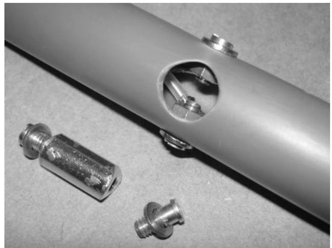
A foto acima à esquerda mostra a conexão do cabo com radiador de VHF já pronta. Um furo de 11mm. de diâmetro, perpendicular aos bornes do radiador de VHF (apenas de um lado do boom) permite inserir as arruelas de pressão e as porcas dos bornes, com ajuda de uma pinça:
