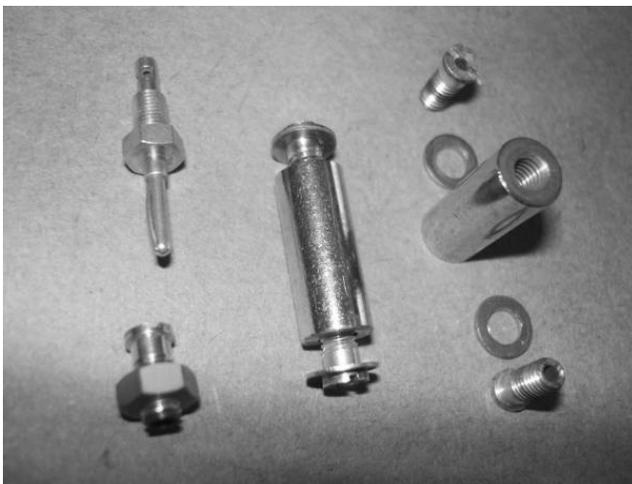
É claro que esta antena pode ser montada de muitas outras formas, como por exemplo, com pinos banana comuns de 4 mm de diâmetro. Se o espaço ocupado pela antena desmontada não é problema, então os refletores podem ser feitos de uma peça só, com outra forma de fixação ao boom. É só usar a criatividade! O que importa mesmo, é a forma de ligar os dipolos ao coaxial e as medidas finais dos elementos.
