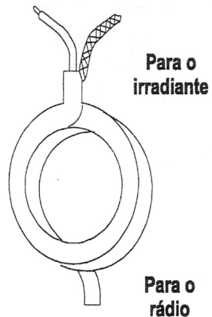
Fig. 2 – “Choke” (reator de R.F.) feito para a conexão do cabo coaxial
