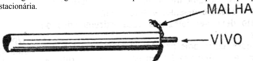
Fig. 2 – Nas pontas do cabo da antenna e dos baluns foram retirados 2,5cm. do isolamento externo, dobrada a malha e retirado o isolamento do condutor central.
