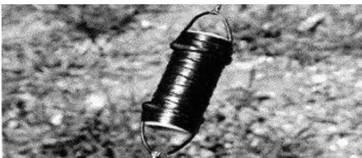
Comece a montagem da antena soldando os fios ou cabos flexíveis ao isolador central, no caso o Balun de Ferrite – relação 1:1. A medida não é exata, podendo variar conforme a bitola e marca de cada fio a ser utilizada, apenas como base inicial, corte, aproximadamente, 10 metros e 60 centímetros para cada lado, esta é a medida da antena para a banda dos 40 metros:
