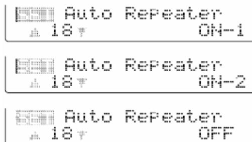
Ajuste a função auto-repetidora ON-1 ou ON-2 no modo de ajuste antecipadamente. Quando a opção ON-1 ou ON-2 estiver configurada, os ajustes de repetidora serão automaticamente ativados de acordo com a tabela a seguir.
