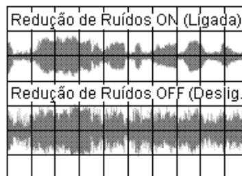
**Dica!** O quanto você avança o controle NR → NOTCH determina o quanto o ruído será reduzido. Se este controle for muito girado em sentido horário, poderá haver distorção no sinal recebido. O controle NR → NOTCH deve ser girado apenas o necessário no sentido horário. Use este controle, junto com ganho de RF, NB (reduzidor de ruídos, se necessário), e filtros de FI para minimizar os efeitos do ruído sobre o sinal alvo.
