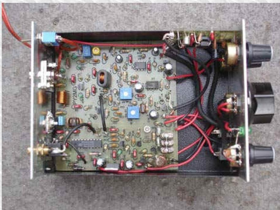
Transceptor Pinel II (caseiro CW - 40 metros) - detalhes em [www.py2mg.qsl.br](http://www.py2mg.qsl.br)
