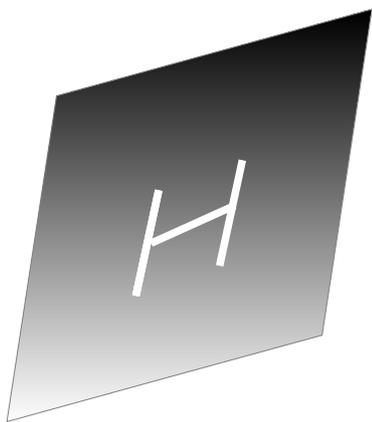
Corte uma chapa de metal quadrada e faça um rasgo no centro em forma de “H”. Dobre as pontas internas da chapa conforme o desenho. As duas aletas recebem parafusos para fixar a gôndola, que neste caso é um ferro tubular quadrado.
