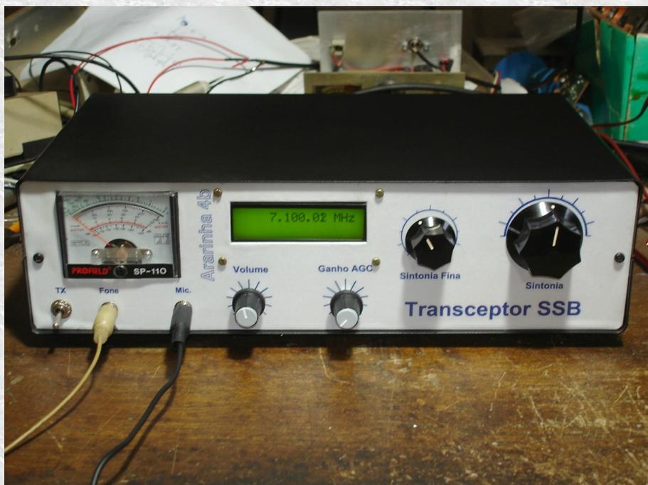
Transceptor Ararinha SSB (caseiro - 40 metros) - detalhes em [www.py2mg.qsl.br](http://www.py2mg.qsl.br)
