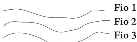
Faça assim, ó: pegue três pedaços de fio esmaltado, e simplesmente enrole eles junto, fazendo as espiras especificadas. Com um multímetro, você identifica as pontas iniciais e finais de **cada um** e faz a interligação final. Veja que na página seguinte, o balun tem as espiras ligadas em série.
