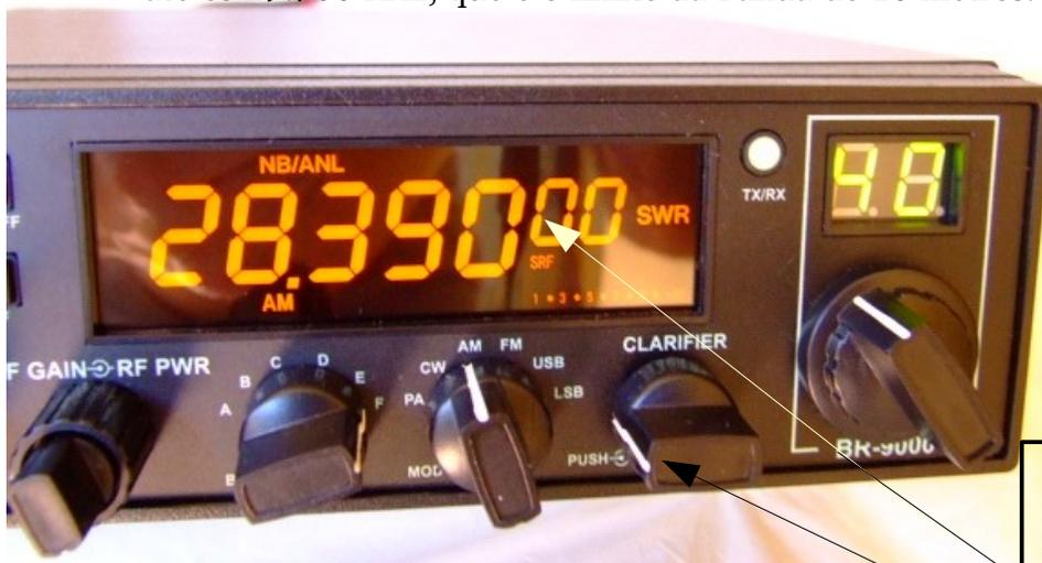
Se você se esquecer e usar o botão de canal, ele volta aos canais da banda F. Volte para o canal 40 e você encontrará a frequência onde parou. Ela fica memorizada.
