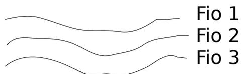
Faça assim, ó: pegue três pedaços de fio esmaltado, e simplesmente enrole eles junto, fazendo as espiras especificadas. Com um multímetro, você identifica as pontas iniciais e finais de *cada um* e faz a interligação final. Veja que na página seguinte, o balun tem as espiras ligadas em série.
