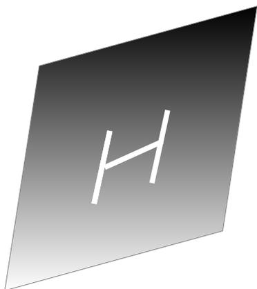
Corte uma chapa de metal quadrada e faça um rasgo no centro em forma de "H". Dobre as pontas internas da chapa conforme o desenho. As duas aletas recebem parafusos para fixar a gôndola, que neste caso é um ferro tubular quadrado.
