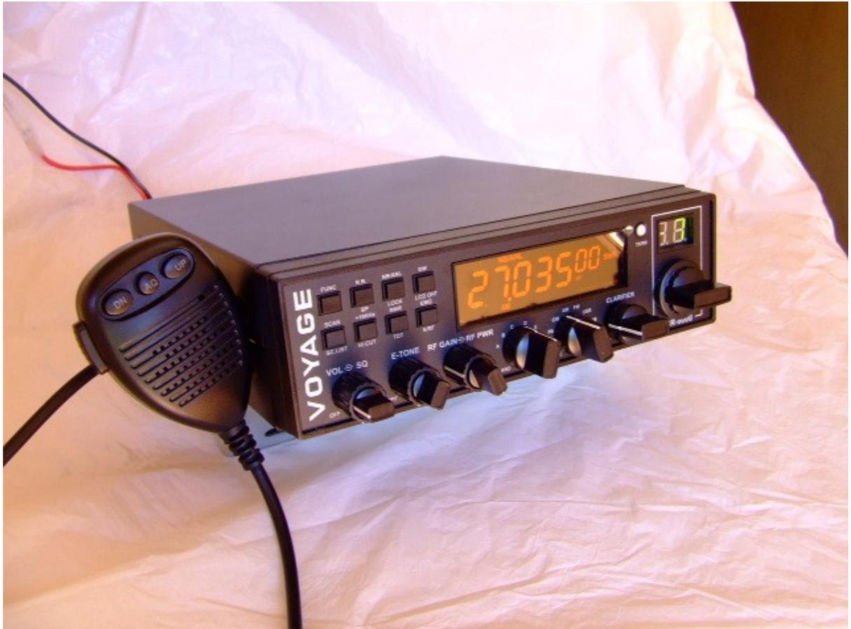
Se você comprou um Voyage BR-9000 e tem licença como Radioamador, pode usufruir a banda dos 10 metros. Este aparelho não precisa de programação via computador. Basta colocar na banda F, canal 40. Empurre o clarificador até selecionar o penúltimo dígito (1 KHz). Agora mude a frequência usando o próprio botão do `clarifier`. Embora caia um pouco o rendimento, você chegará facilmente até os 29.700 KHz, que é o limite da banda de 10 metros.
