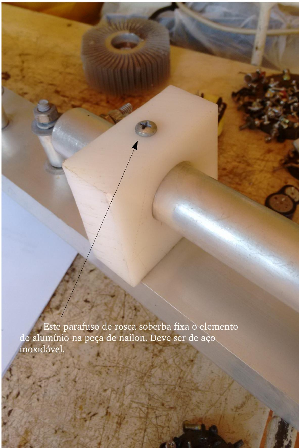
Este parafuso de rosca soberba fixa o elemento de alumínio na peça de nylon. Deve ser de aço inoxidável.
