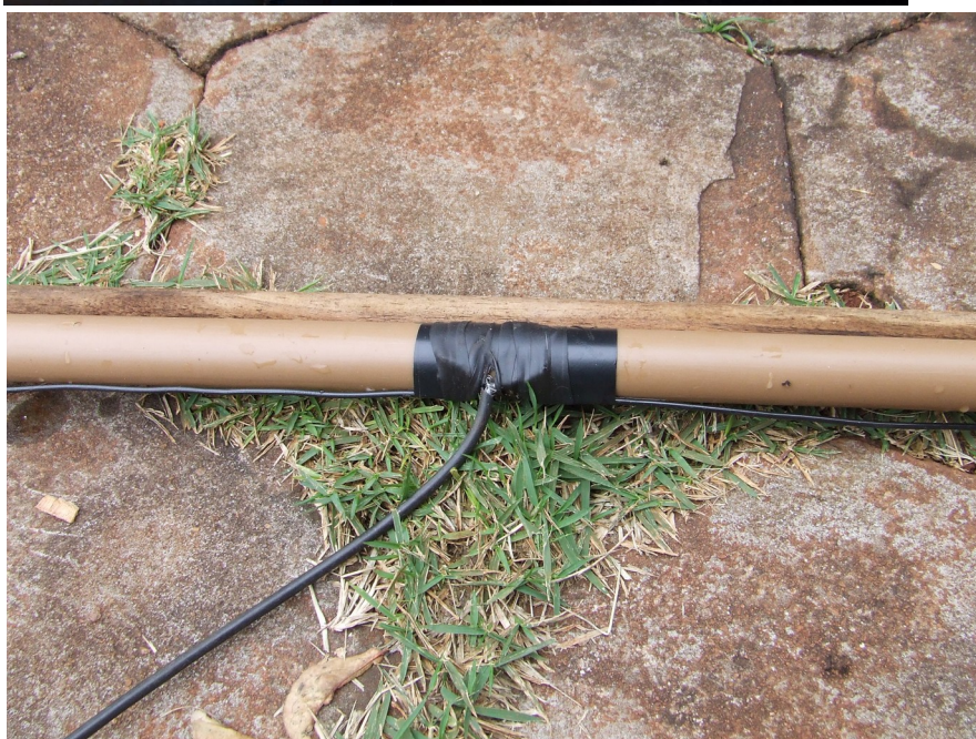
Centro da antena e ligação do cabo coaxial
