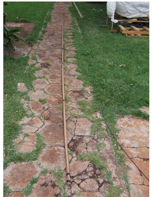
A ANTENA DIPOLO DE FIO/PVC
