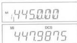
No modo de espera, pressione a tecla **V/M** ou a tecla **VFO/MR** até **M** aparecer, isto indica o canal atual no modo do canal. Repita esta operação para mudar entre o modo da frequência (VFO) e o modo do canal.
