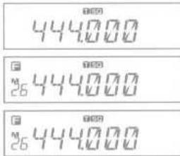
1. No modo de frequência (VFO), gire o botão seletor para selecionar a frequência desejada ou a frequência marcada com as teclas numéricas no microfone.
