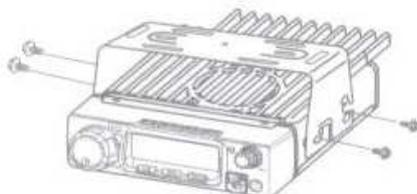
3. Determine o ângulo apropriado da unidade, usando as 3 posições de furo na lateral do suporte de montagem.
